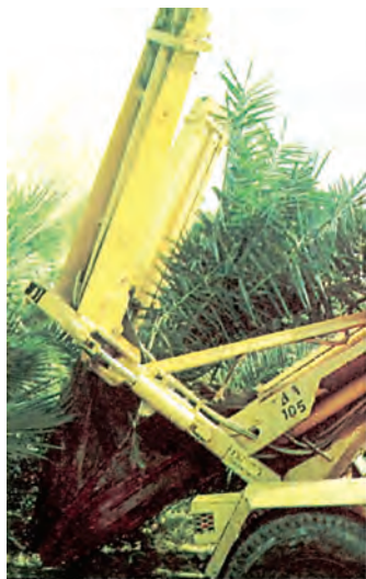
1. Εξαγωγή του φοίνικα από το έδαφος με μηχανήμα που βγάζει μπάλα κωνικού σχήματος
