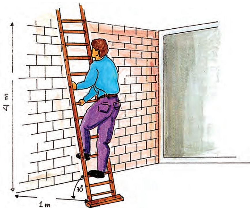
Εικ. 16.18 Η κατάλληλη κλίση που πρέπει να έχει η σκάλα, έτσι ώστε η εργασία να γίνεται με ασφάλεια.
