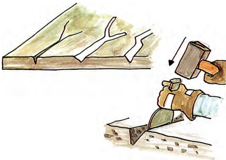
Εικ. 14.1 Αποκατάσταση ρωγμών σε διάδρομο από μπετόν
