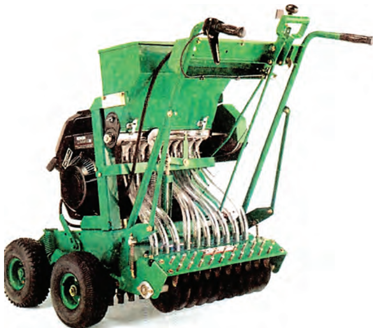
Εικ. 2.32 Ολοκληρωμένο μηχανήμα συντήρησης χλοοτάπητα, που συγχρόνως αερίζει, σπέρνει, λιπαίνει και καλύπτει τον ταλαιπωρημένο χλοοτάπητα.
