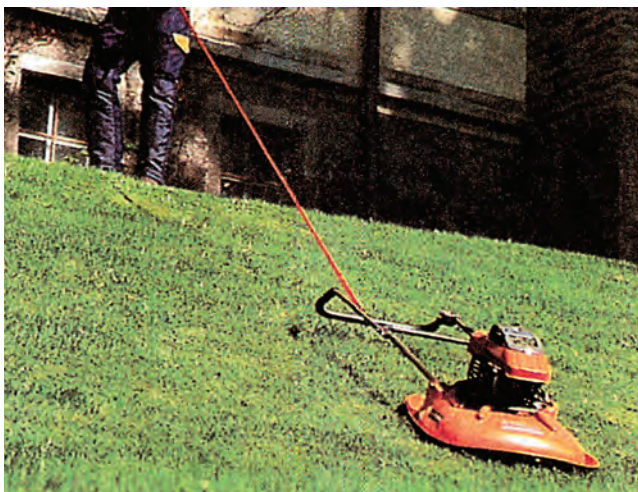
Εικ. 2.7 Χλοοκοπτικό μηχανήμα με μεσινέζα, που χρησιμοποιείται σε χλοοτάπητες με μεγάλη κλίση.
