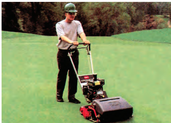
Εικ. 2.3 Χλοοκοπτικό μηχανήμα κυλινδρικού τύπου
