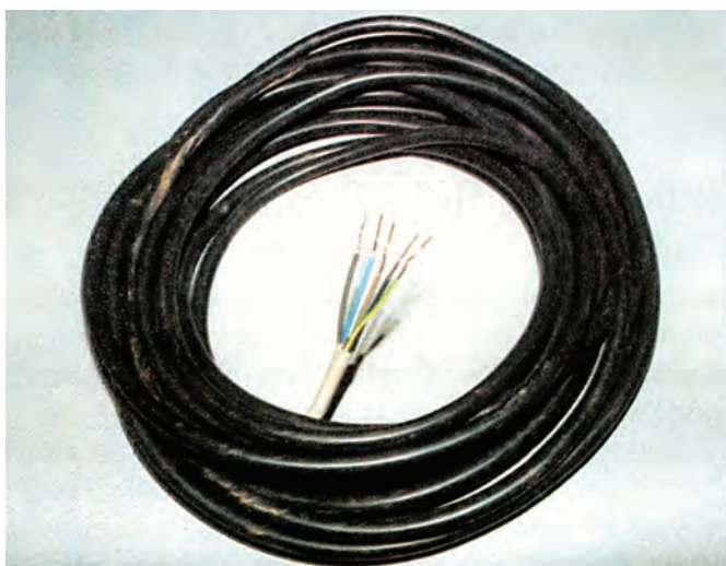
Εικ. 15.4 Καλώδιο ανθυγρά (NYY) που χρησιμοποιείται στην εγκατάσταση αυτόματου ποτίσματος και συνδέει τον Ηλεκτρονικό Προγραμματιστή με τις Ηλεκτροβάνες.
