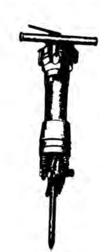
Εικ. 150 Κρουστικό χειροκίνητο μηχάνημα (αερόσφυρα).
