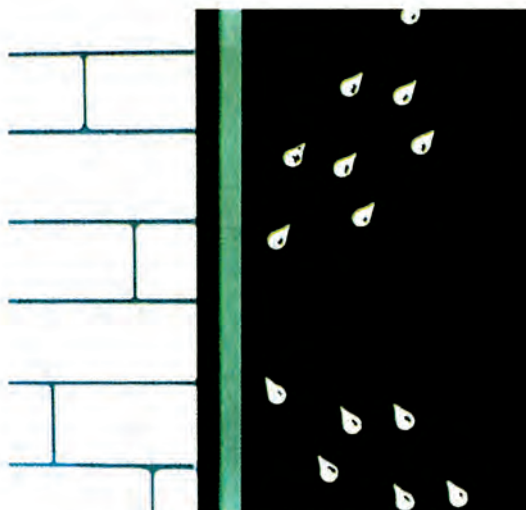
Εικ. 240 Προστασία εξωτερικού τοίχου με υδατοαπωθητικά διαλύματα.
