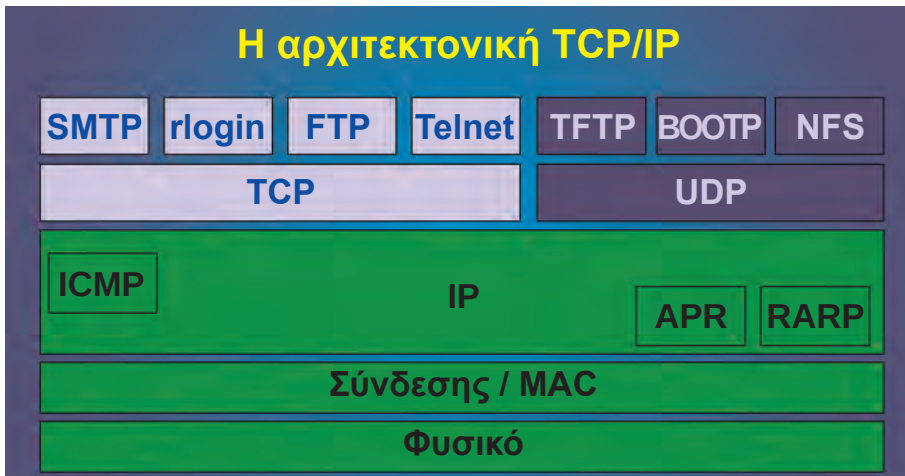
Σχήμα 9.1.3 Η δομή της TCP/IP αρχιτεκτονικής
