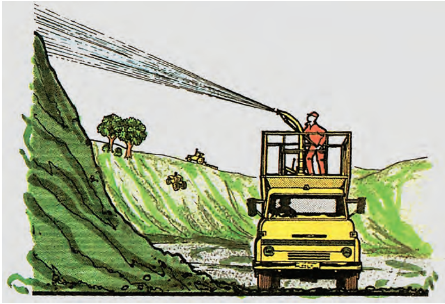
Σχήμα 9-2: Υδροσπορά με εκτόξευση πυκνού υγρού σπορομίγματος (60% στερεά) από μηχανικά μέσα ικανότητας max εκτόξευσης 60 και πλέον μέτρα. Επέκταση του εκτοξευτήρα με μάνικες είναι δυνατή για κάλυψη επιφανειών δύσκολης προσπελασιμότητας. Φωτ. 9-17: Φυσικός εποικισμός του δάσους την επόμενη άνοιξη μετά από το χρόνο εκδήλωσης της πυρκαγιάς. (Πηγή: Αρχείο Αικ. Σκοτίδα)
