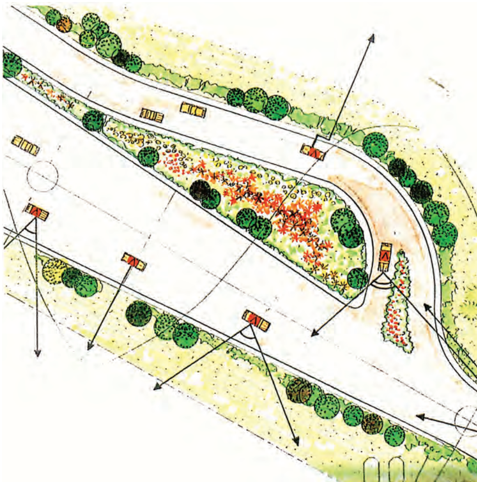
Σχήμα 7-2 και 7-3: Σχεδιασμός φύτευσης συγκοινωνιακών κόμβων. Θέες κατά την κίνηση των οχημάτων είναι ελεύθερες χωρίς φύτευση για τον πλήρη έλεγχο του πεδίου οδήγησης (Πηγή: Αρχείο Σ. Σεκλιζιώτη).
