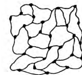
Σχ. 13/10: Δομή των ελαστομερών
