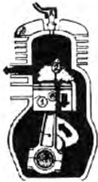
Σχ. 6/13: Καταπόνηση διωστήρα μηχανής εσωτερικής καύσης σε λυγισμό.
