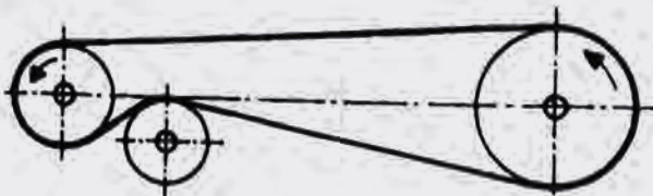
Σχ. 2/9: Σύστημα ιμαντοκίνησης με τανυστήρα
