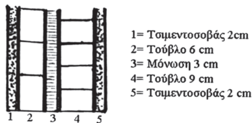
Εικ. 15.14 Τομή εξωτερικού τοιχώματος υποστασίου
