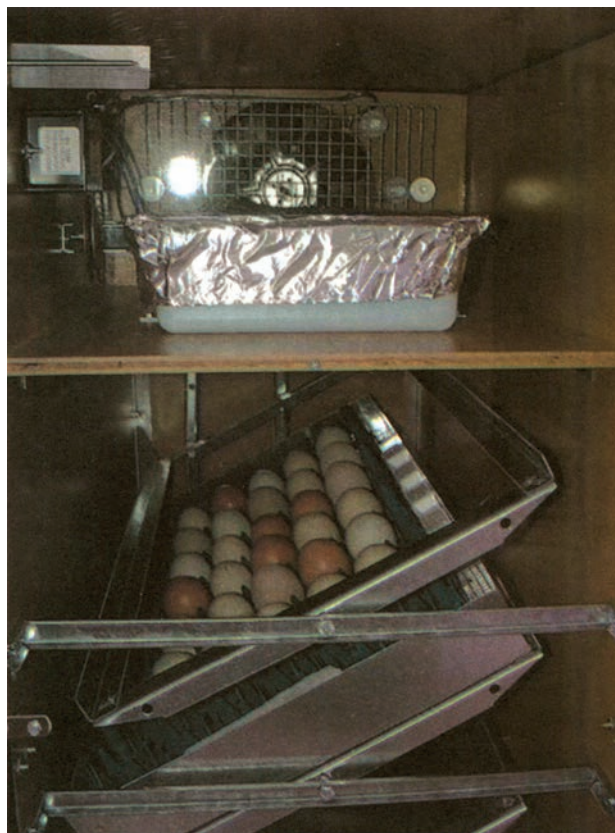
Εικ. 11.4 Εσωτερικό επωαστικής μηχανής
