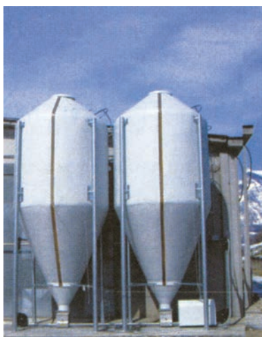
Εικ 5.8 Κατακόρυφες αποθήκες (Silos) καρπών από PVC
